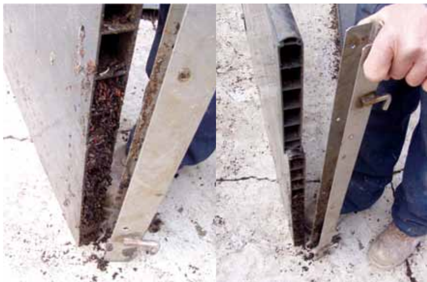
Фото 2. Пустотелые панели через 1,5 года эксплуатации
