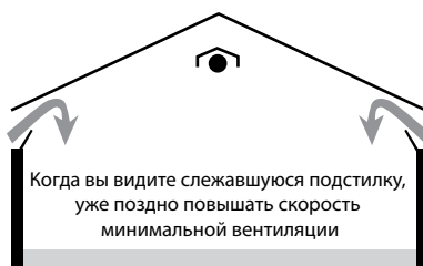
РИС. 1. ПРИ ТАКОМ РАСПРЕДЕЛЕНИИ ВОЗДУХА ЕСТЬ РИСК «СПЕКАНИЯ» ПОДСТИЛКИ.
